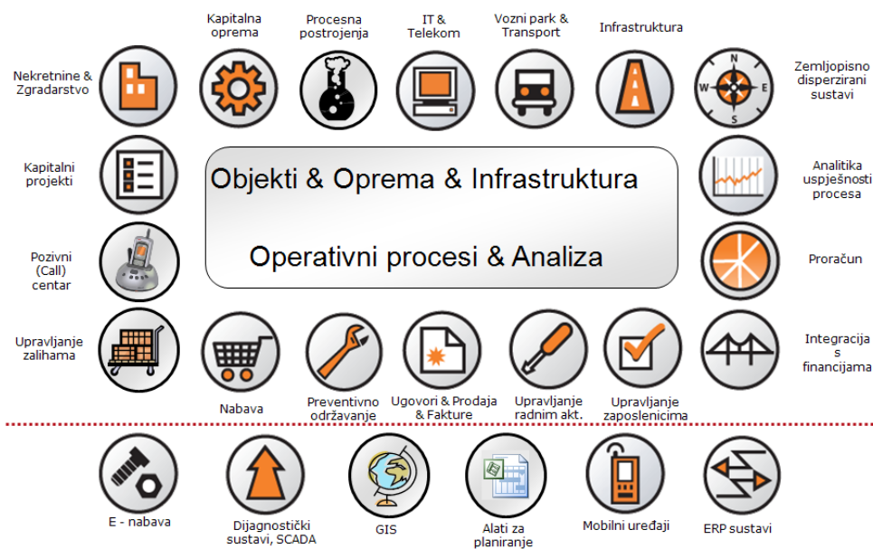
Slika 1. Struktura suvremenog informacijskog sustava za podršku upravljanju održavanjem
