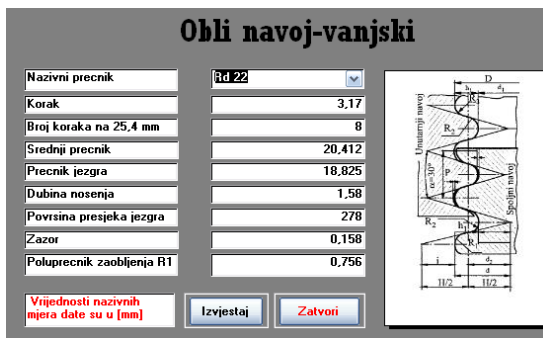
Slika 9. Forma „Obli navoj – vanjski“
