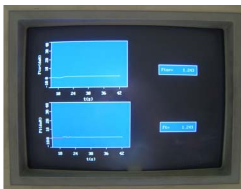
Slika 13. Signal trenutne i srednje vrijednosti sile trenja F_t
