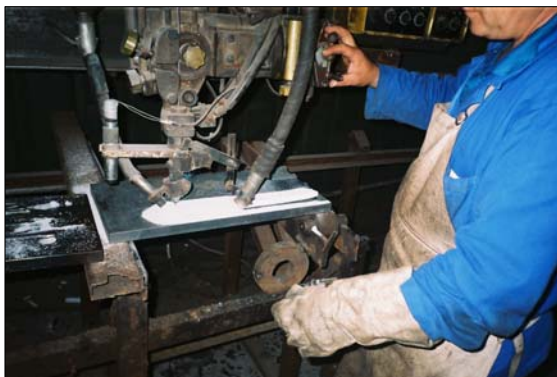
Slika 4. Detalj navarivanja EPP postupkom jedne od dvanaest eksperimentalnih ploča
