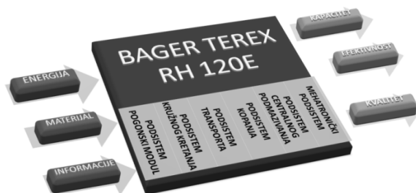
Slika 3. Tehnički sistem bager TEREX RH 120E sa podsistemima
