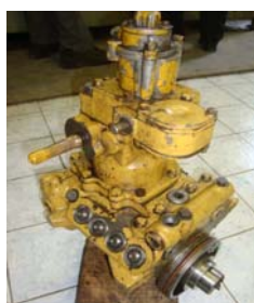
Slika 6. Pumpe goriva s hidrodinamičkim regulatorom
