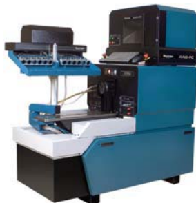
Slika 1. Izgled ispitnog stroja (ispitni - probni stol) Hartridge AVM2-PC
