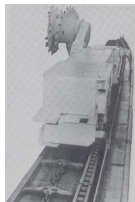
Slika 2. – Montaža otkopne mašine na čelnom grabuljaru
