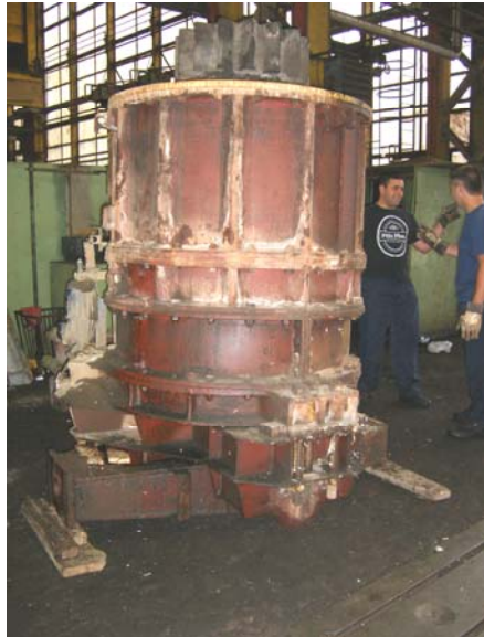
Slika 2. Izgled reduktora posle pranja, čišćenja i odmašćivanja
