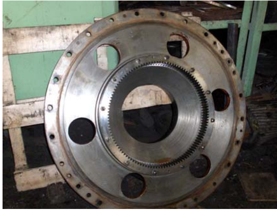
Slika 7. Zvono malog planetarca
