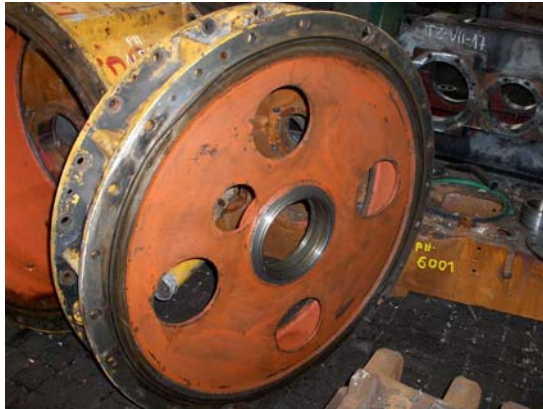
Slika 8. Demontirani poklopac kućišta (gornji)
