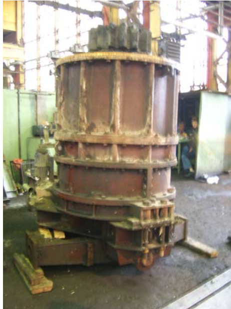
Slika 3. Planetarni reduktor sa postoljem
