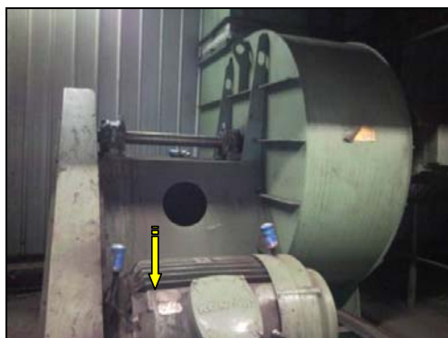
Slika 3. Otkriveno oštećenja ležaja
