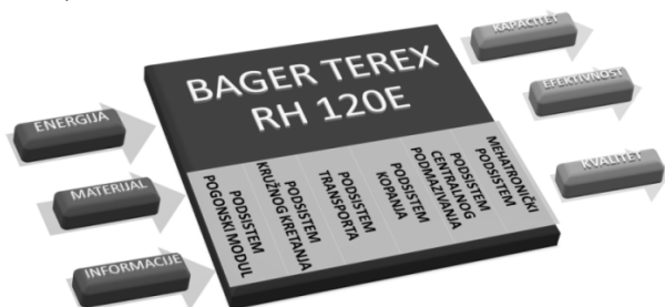
Slika 5– Tehnički sistem bagera TEREX RH 120E sa podsistemima
