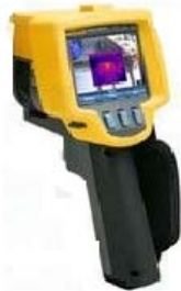
Slika 2. Termovizijska kamera FLUKE Ti10 [3]
