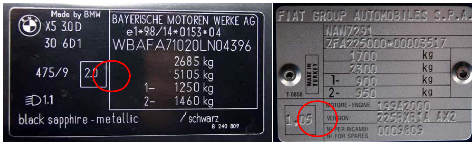
Slika 2. Podaci o zacrnjenosti izduvnih gasova dizel motora
