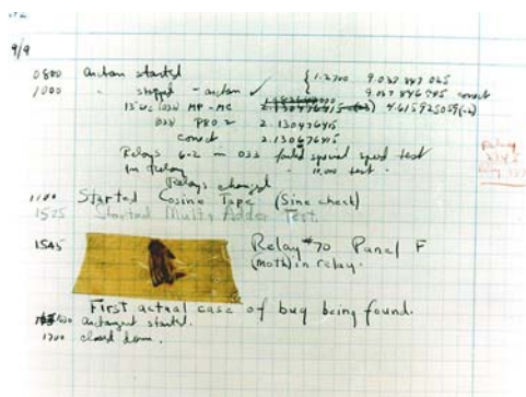
Slika 1. Izvještaj o greški u računaru Mark II koju je izazvao moljac – prva upotreba termina "bug" za greške u radu računara [3]
