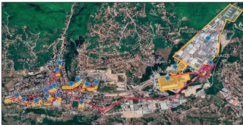
Slika 1. Distributivna mreža, toplotne podstanice i grijani objekti u Vogošći
