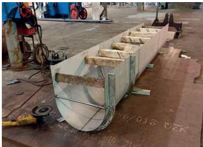
Slika 6. Korito transportera sastavljeno od dijelova lima nakon operacije savijanja i zavarivanja [1]
